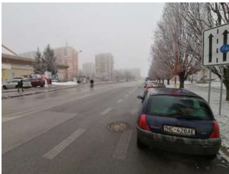
Obrázok 19 Cyklopruh vložený medzi cestnou a statickou dopravou
